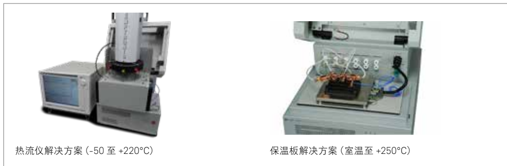
图 6. B1506A 支持的温度测试解决方案。
