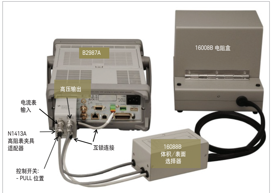
图 3. B2987A 和 16008B 进行电阻率测量的配置
