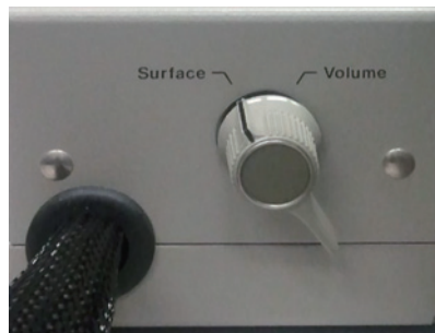
图 4. 16008B 体积/表面选择器的开关
